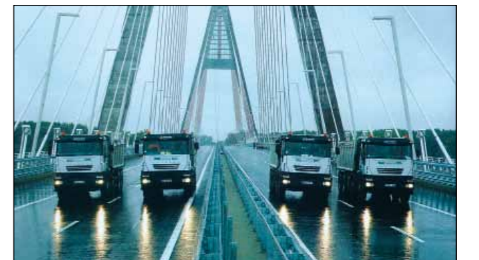
A Megyeri híd dinamikus próbatárhelése (dr. Dunai László felvétele)
